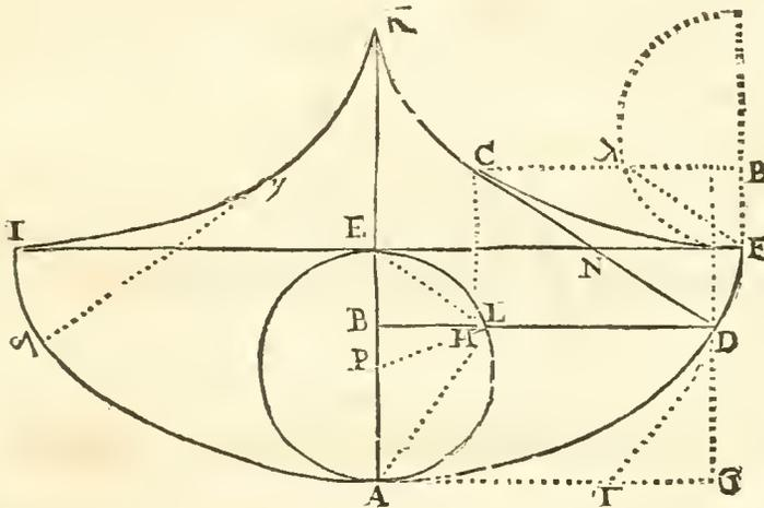
d'abord la Fluxion de la Base ou Abcisse AB est à la Fluxion de l'Arc AL, comme BL est à PL ; c'est-à-dire,  $\dot{x}$  ou 1 :  $\dot{t} :: u : \frac{1}{2}a$ . Ainsi  $\frac{a}{2u} = \dot{t}$ , & par la nature du Cercle  $ax - xx = uu$ , d'où  $a - 2x = 2\dot{u}u$ , ou  $\frac{a - 2x}{2u} = \dot{u}$ .
